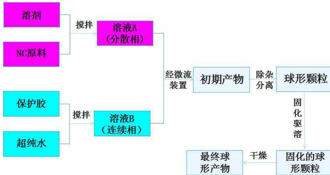
图 3-1 单基球形发射药制备工艺流程图
